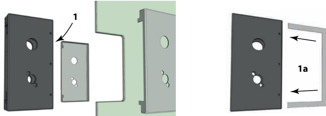
**1. APPLIQUER UN CORDON DE SILICONE STRUCTURAL AU FOND DE LA RAINURE DU CÔTÉ LONG DU BOITIER DE PLASTIQUE.**
