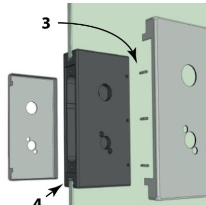
**5. INSTALLER LES COUVERCLES DE FINITION AVEC QUELQUES POINTS DE SILICONE STRUCTURAL POUR MAINTENIR LES COUVERCLES EN PLACE. NE PAS METTRE TROP DE SILICONE AFIN DE FACILITER L'ENLÈVEMENT DES COUVERCLES LORS D'UN ENTRETIEN OU D'UNE RÉPARATION FUTURE.**
